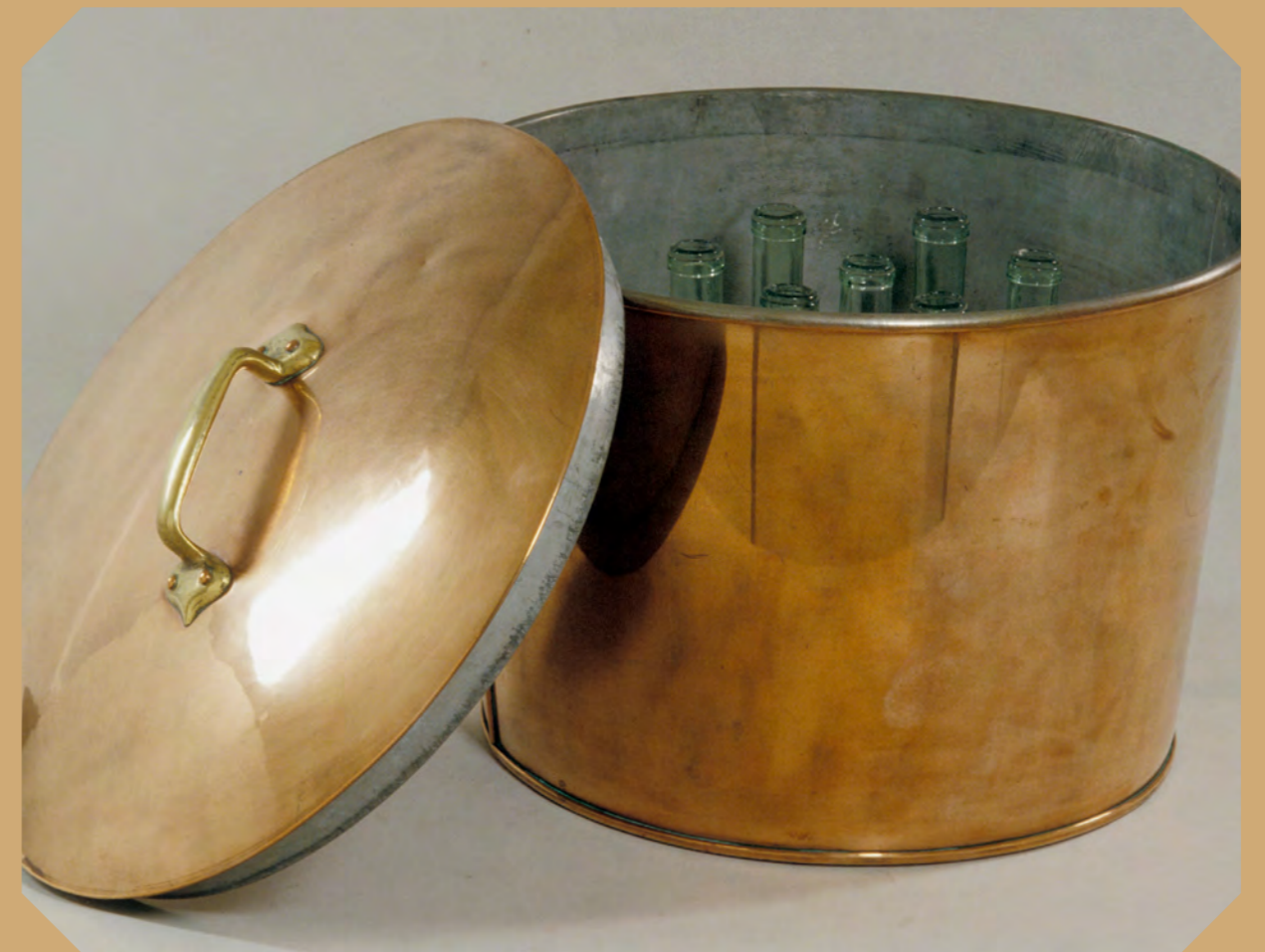
Bain-marie utilisé par Louis Pasteur pour la pasteurisation du vin déjà mis en bouteilles, ce qui évitait une contamination accidentelle durant l'embouteillage, cuve, 1865. © Institut Pasteur / Musée Pasteur
