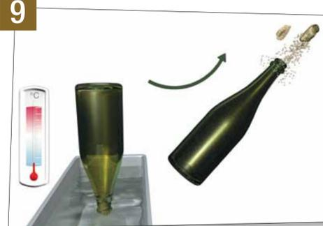
Le goulot de la bouteille est plongé dans une solution glacée. Le dépôt forme un glaçon expulsé par la pression contenue dans la bouteille.
